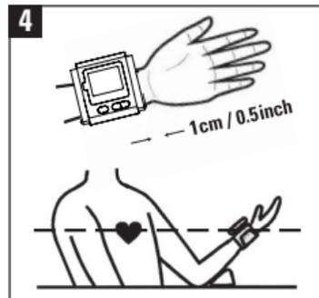
Legen Sie das Gerät so an, dass es ca. 1 cm unter der Handwurzel sitzt und es sich auf Herzhöhe befindet.
