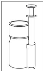
**Abb. 4:** Um die Pipette an der Flasche zu befestigen, nehmen Sie die beiliegende Halterung und ziehen Sie die Klebefolie ab. Kleben Sie nun die Halterung senkrecht an die Flasche, sodass die Standfüßchen der Halterung nach unten zeigen und die Öffnung nach oben gerichtet ist. Stellen Sie die ausgespülte und abgetrocknete Pipette in die Halterung, Pipette und Halterung bilden nun eine Einheit.
