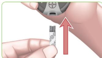
Das Messgerät schaltet sich ein. Sobald das Messgerät für die Messung bereit ist, wird das
