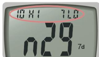
**Durch Drücken von ▲ wird der 7-Tage-Mittelwert angezeigt.**
