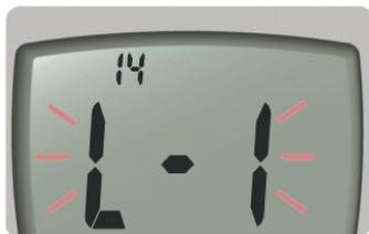
Bei Verwendung des einfachen Modus (auf dem Display wird L-1 angezeigt) ist die Einrichtung des Messgeräts abgeschlossen.
