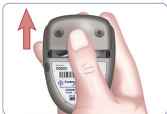
**HINWEIS:** Wenn die neuen Batterien innerhalb von 5 Minuten nach Entfernen der alten Batterien eingelegt werden, bleiben alle Einstellungen und Messergebnisse im Speicher erhalten. Dauert der Batteriewechsel länger als 5 Minuten, müssen Datum und Uhrzeit neu eingestellt werden; alle anderen Einstellungen bleiben erhalten.
