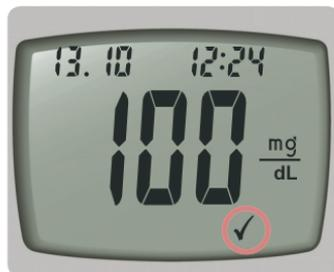
**HINWEIS:** Das ✓ bedeutet jedoch nicht, dass ein Kontrollmessergebnis innerhalb des vorgegebenen Bereichs liegt. Es zeigt lediglich, dass es sich um eine Messung mit Kontrolllösung handelt. Diese Messung wird nicht in die Mittelwertbestimmung aufgenommen.
