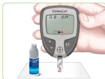
7. Die **Messöffnung** des Sensors sofort an den Kontrolllösungstropfen halten. Die Kontrolllösung wird durch die Messöffnung in den Sensor eingesaugt.
