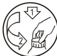
Zum Öffnen Verschlusskappe nach unten drücken und gleichzeitig in Pfeilrichtung drehen. Nach Gebrauch muss die Verschlusskappe wieder fest zuge dreht werden, damit die Kindersicherung erneut gewährleistet ist.
